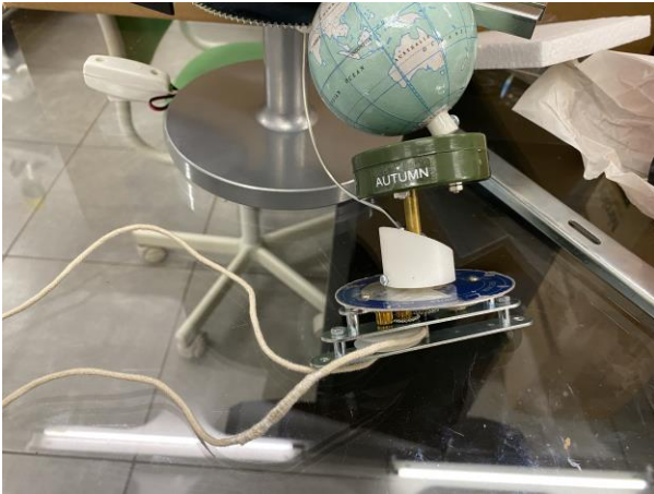
Εικόνα 7 - Στη συνέχεια εντοπίστε το μηχανισμό κίνησης ΓΗΣ – ΣΕΛΗΝΗΣ. Ξεμπλέξτε το σχοινί (ιμάντας μετάδοσης – transmission belt )
