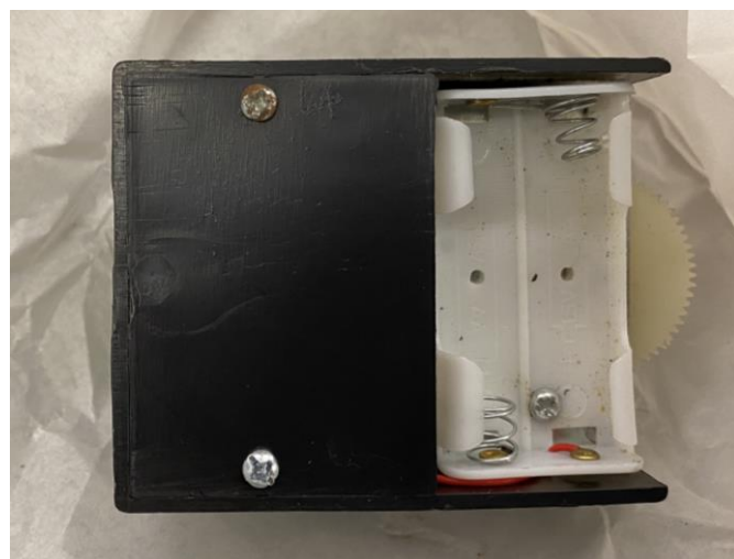
Εικόνα 2- Η κάτω μεριά του μηχανισμού κίνησης – όπου υπάρχει η μπαταριοθήκη (χρειάζονται 2xAA μπαταρίες)
