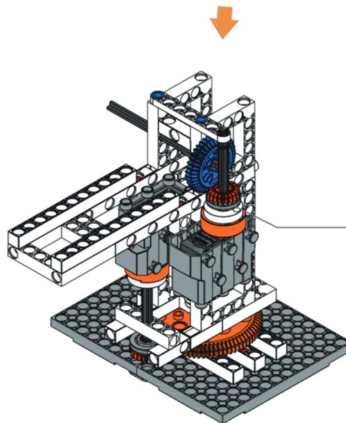
Προσοχή στη διεύθυνση του άξονα και στη συναρμολόγηση του γριναζιού.
