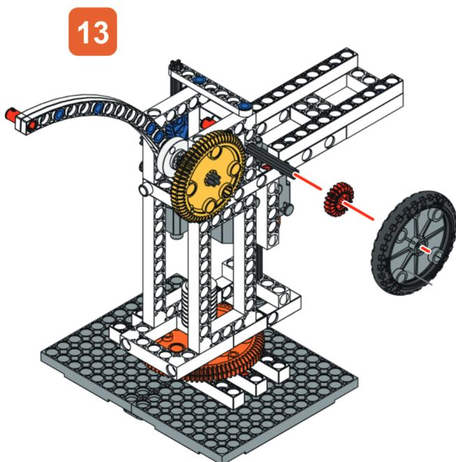
Συναρμολογούμε τον άξονα στη μέση. Το κόκκινο γρανάζι τοποθετείται δεξιά, όπως φαίνεται.
