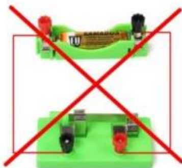
Λανθασμένη σύνδεση!!! Βραχυκύκλωμα πηγής.
