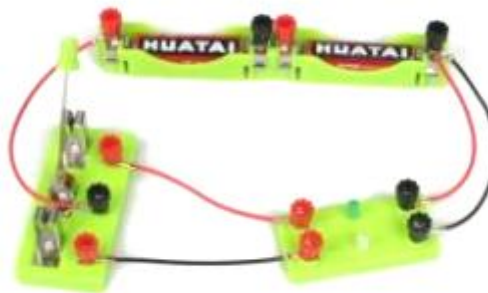
Κύκλωμα με δύο διόδους LED με εναλλαγή.
