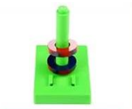
Πείραμα επίδειξης μαγνητικής αιώρησης δακτυλίων.
