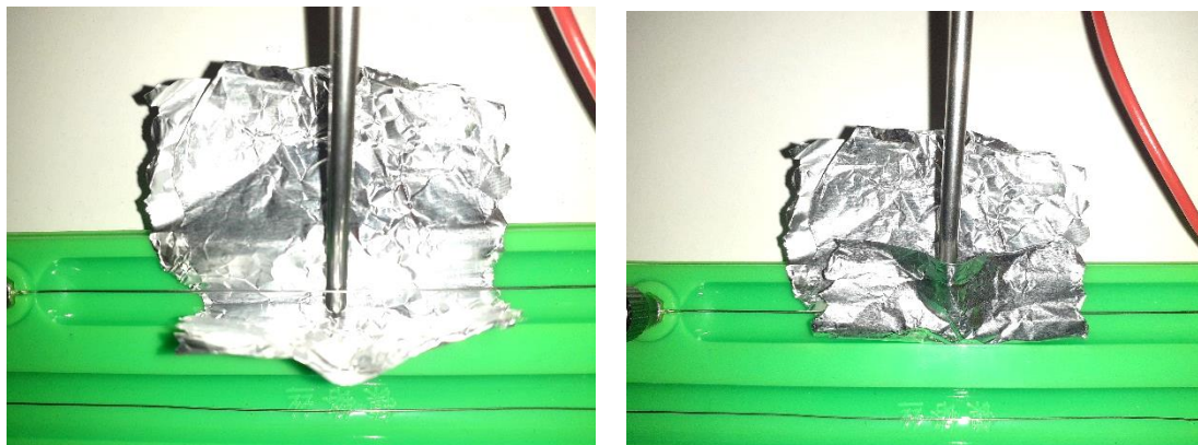
Τύλιγμα αλουμινόχαρτου γύρω από τον αγωγό και την άκρη του αισθητήρα.
