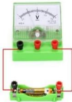
Μέτρηση τάσης μιας μπαταρίας.
